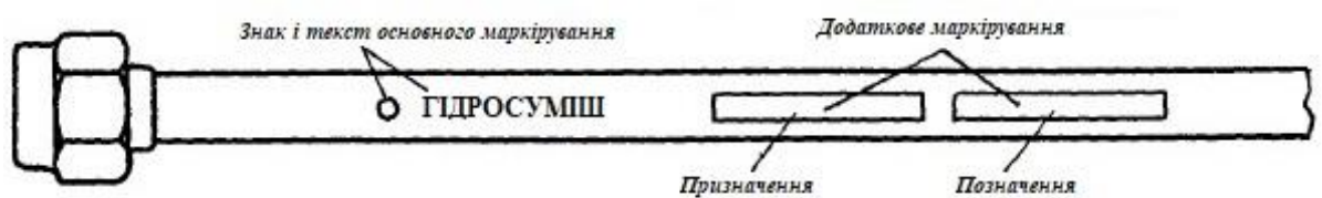
Рисунок 2.4 - Маркірування трубопроводів гідравлічної системи
