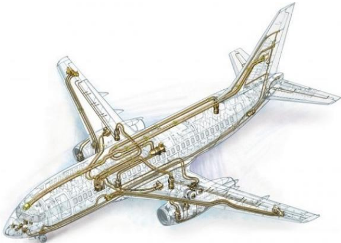
Рисунок 2.3 - Принципова схема гідравлічної системи літака
