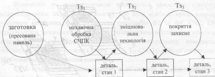
Рис. 2.8. Послідовність перетворень при виготовленні деталі механічною обробкою
