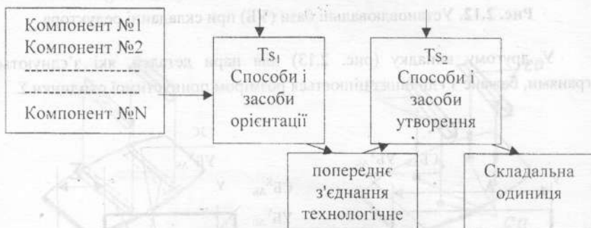
Рис. 2.11. Схема перетворення при складанні
