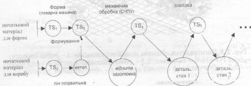
Рис. 2.5. Перетворення при виробництві деталі з відливої заготовки
