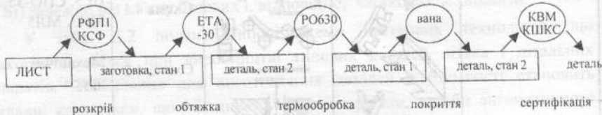
Рис. 2.2. Схема перетворень при виготовленні типових деталей
