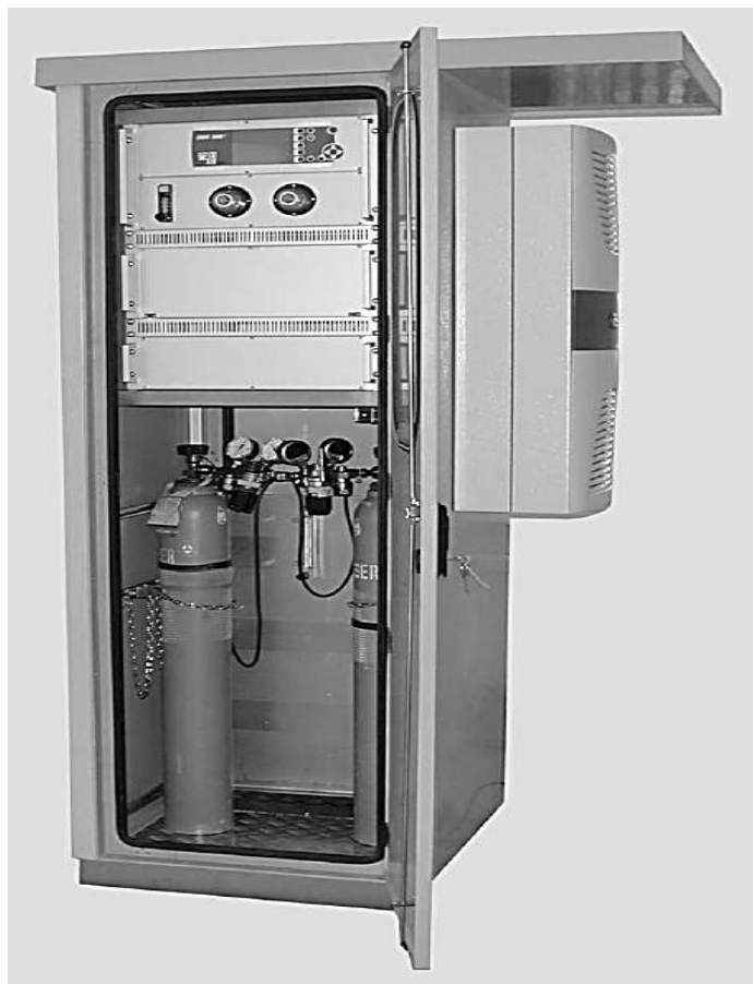
Рис. 4.7. Газоаналізатор MRU SWG-300
