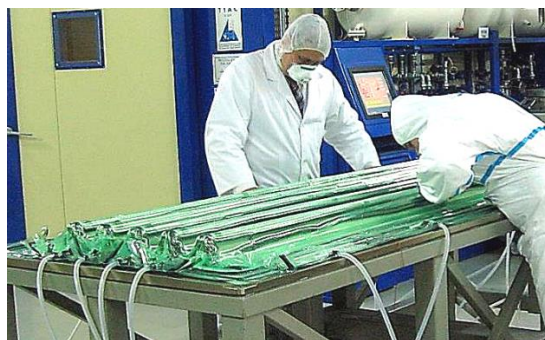
Рисунок 2.10 - Вакуумування виклеєчних форм композитних пакетів:
