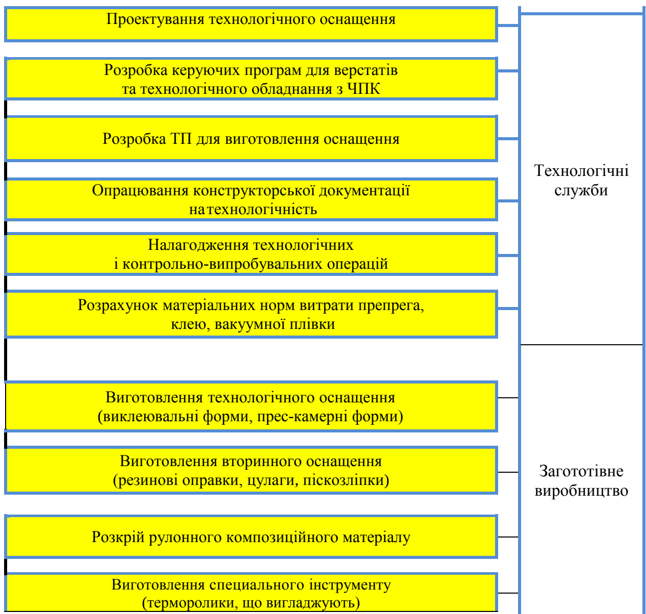
Рисунок 2.1 – Схема ТПВ авіаційних конструкцій із ПКМ
