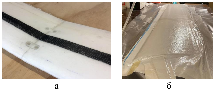
Рисуюнок 2.28 – Загальний вигляд: а - пінопластового заповнювача крила з полицею лонжерону; б - вакуумного мішка для формування крила
