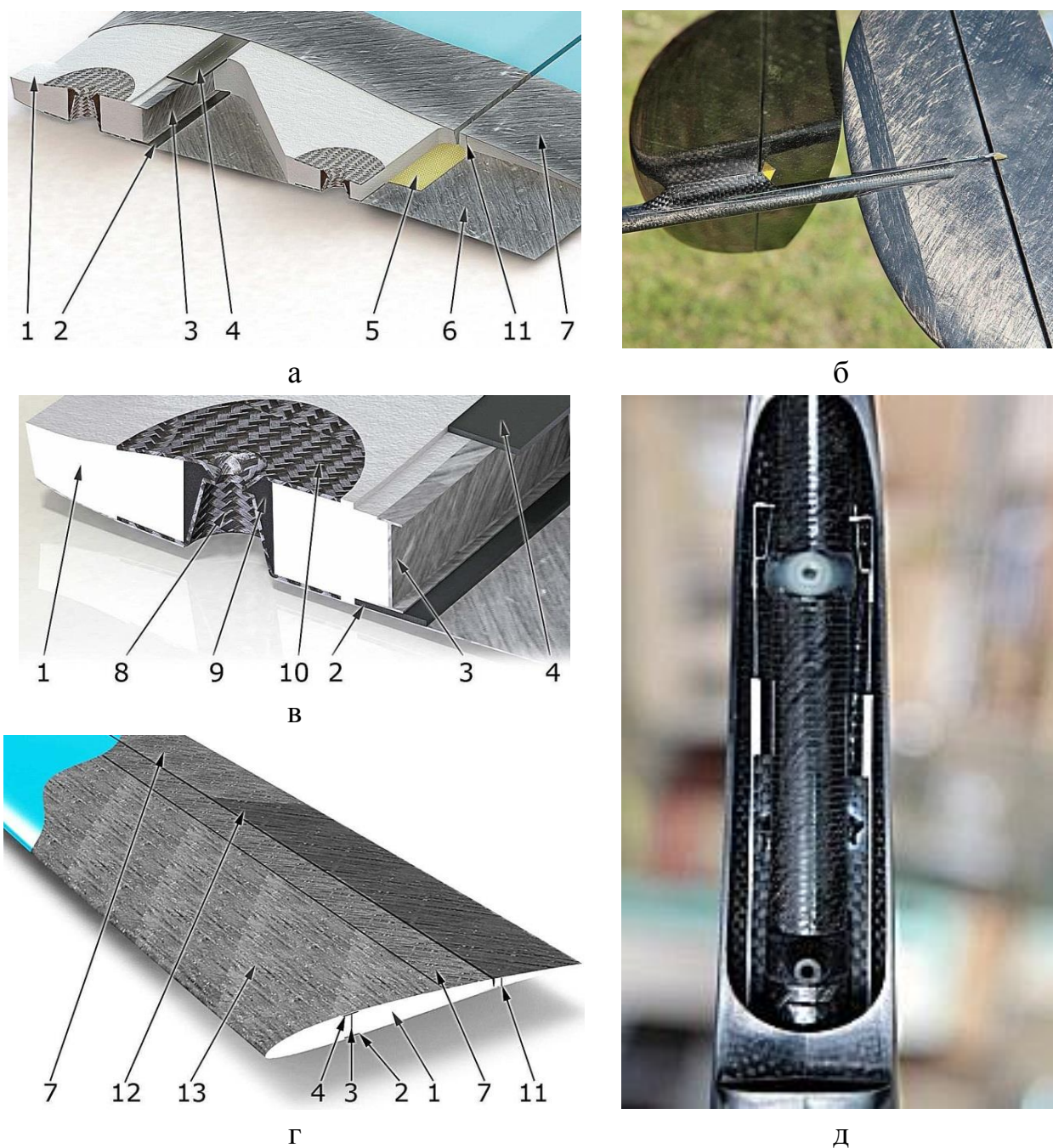
Рисунок 1.5 - Компонування крила та загальний вигляд деяких вузлів планера «Snipe»: а, в, г - компонування крила: 1 - пінопластовий заповнювач крила; 2, 4 - полиця лонжерона; 3 - стінка лонжерону; 5 - торсіон; 7, 13 - обшивка крила; 6, 12 - обшивка елерону; 8 - колодка стику; 9 - вставка; 10 - накладка; 11 - пінопластовий заповнювач елерону; б - загальний вигляд хвостового оперення; д - розташування тяг управління у центральній частині фюзеляжу
