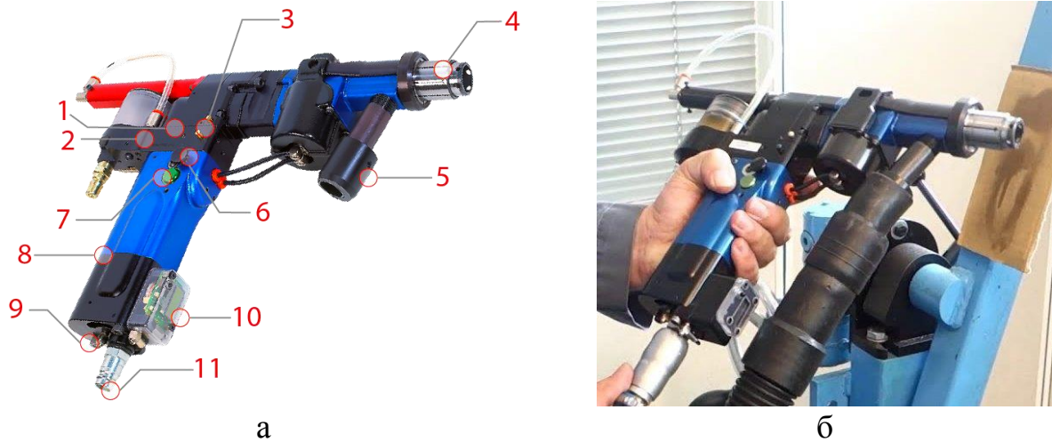
Рисунок 4.10 - Компонувальна схема (а) та загальний вигляд (б) СМАП ST1200:
