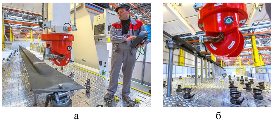
Рисунок 2.14 - Підгонка поверхонь пакету з ПКМ на верстаті з ЧПК
