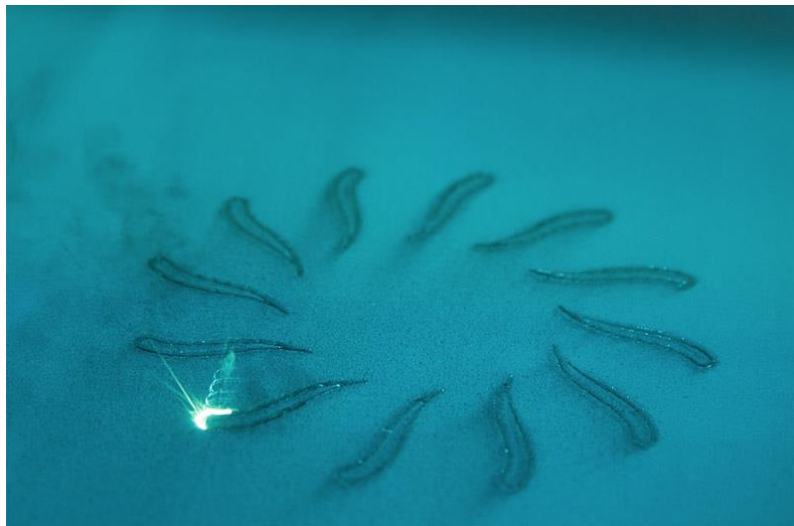
Рисунок 4.22 – Процес друку деталі
