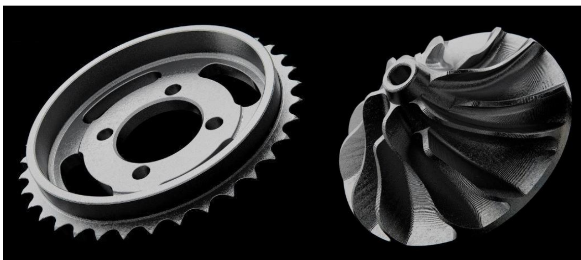
Рисунок 4.14 – Деталі, надруковані на Markforged Metal X
