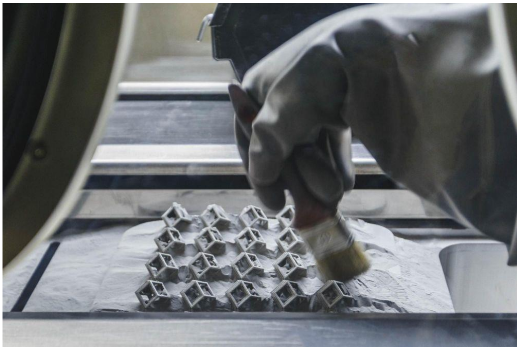
Рисунок 4.10 – Видалення порошку навколо деталей
