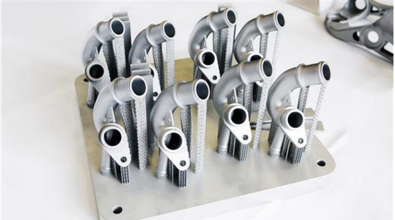
Рисунок 4.17 – Металеві 3D-друковані конектори системи охолодження двигуна AUDI W12
