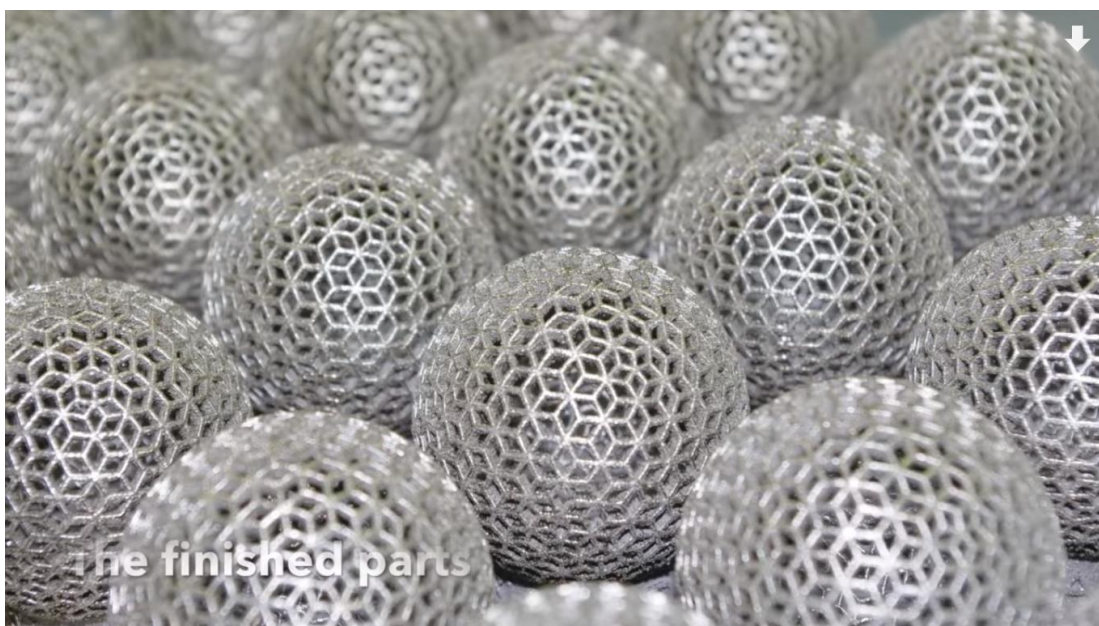
Рисунок 4.16 – Приклад деталі на Concept Laser X Line 2000R
