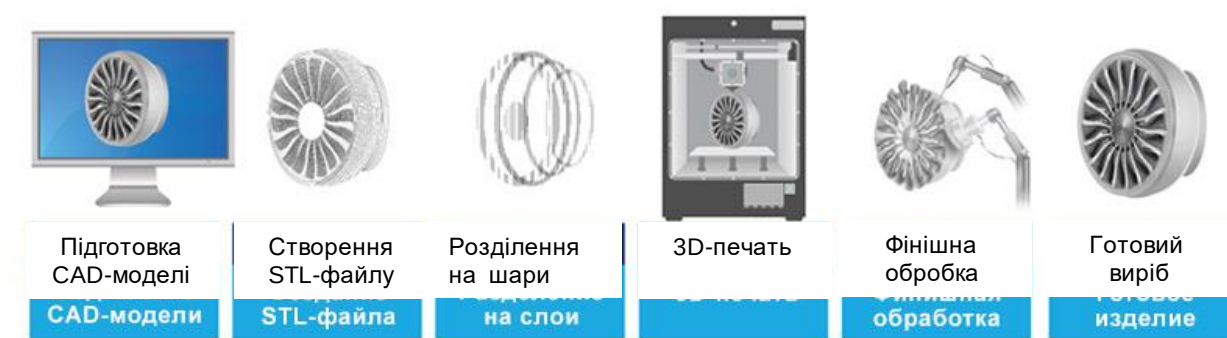
Рисунок 4.1 – Схема адитивного виробництва
