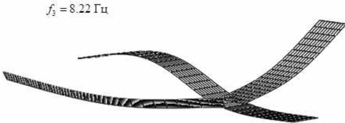
Рис. 99. Симетричний другий тон пружних коливань
