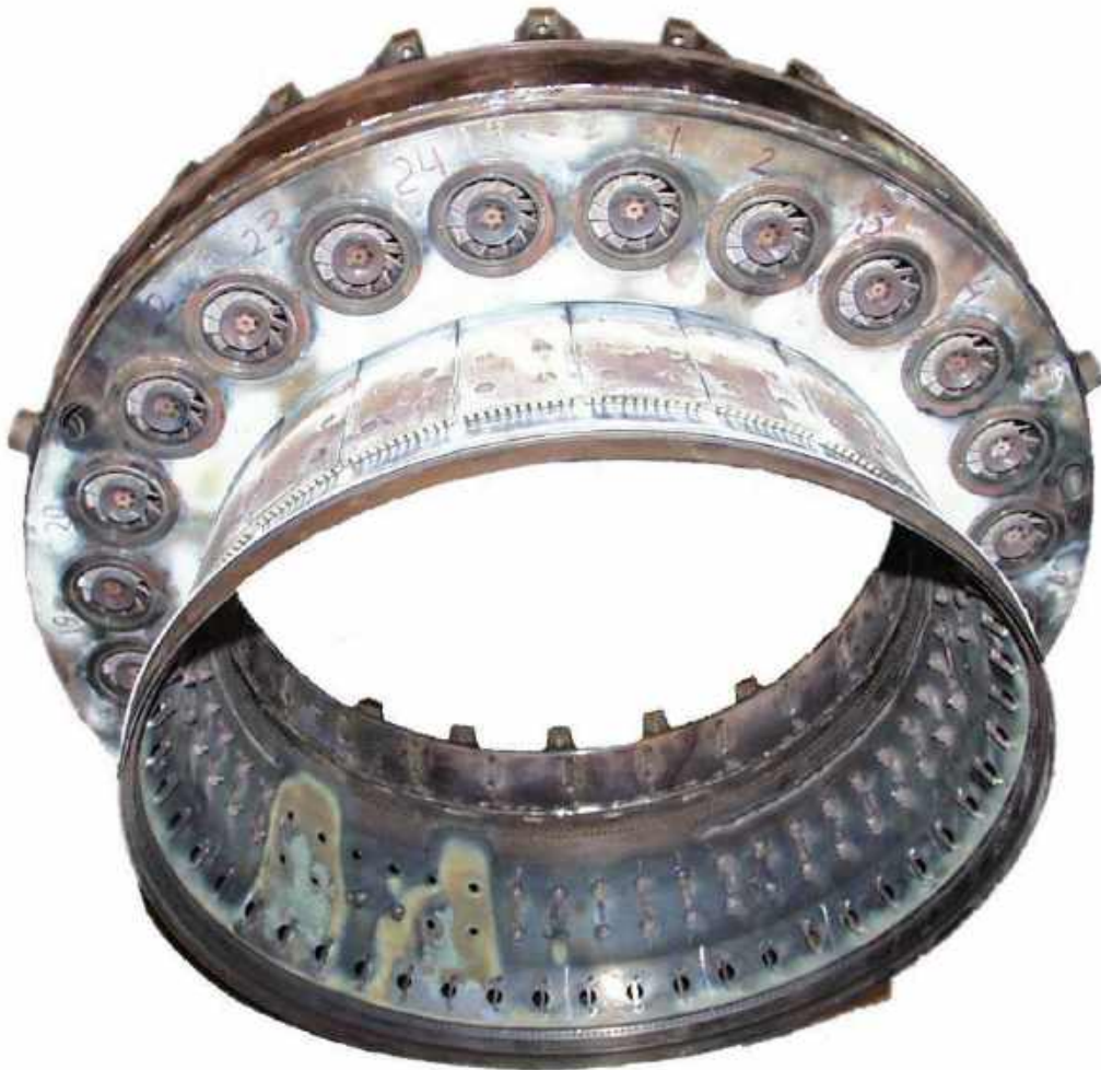
Рисунок 2.4 – Фронтний пристрій КЗ двигуна Д-36 з внутрішньою оболонкою жарової труби
