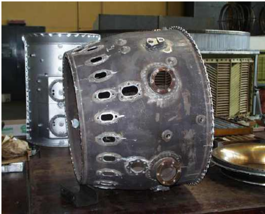
Рисунок 2.22 – Зовнішній корпус камери згоряння двигуна Д-36
