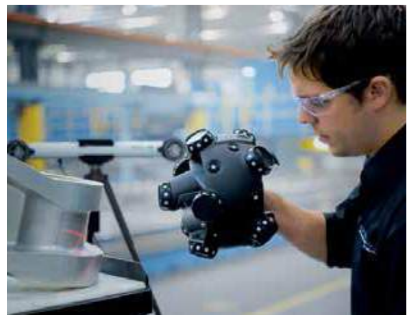
Рисунок 4.10 – Прив'язування ручного лазерного сканера до об'єкта
