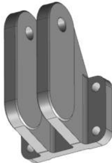
Рисунок 5.17 – Типи елементів складальної оснастки, що монтуються: а – вилки; б – вушка; в – висувні фіксатори; г – упори
