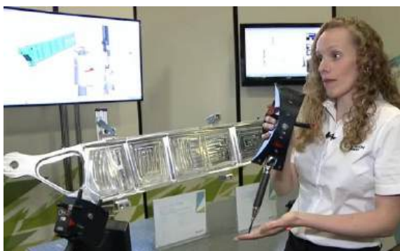
Рисунок 5.8 – Відновлення захоплення лазерного променя відбивачем при роботі в режимі XtremeADM
