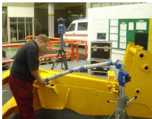
Рисунок 5.9 – Спільна робота лазерного трекера і мобільної КВМ
