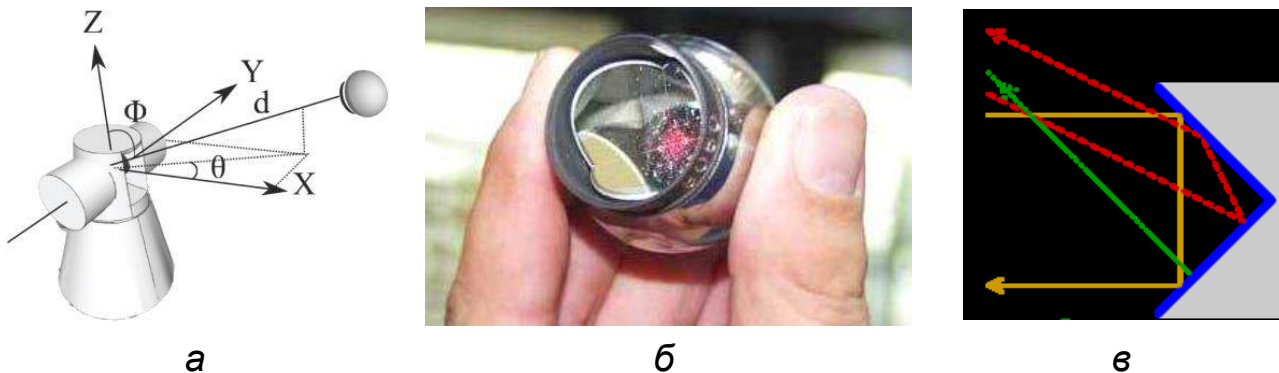
Рисунок 5.1 – Принцип координатних вимірювань лазерним трекером
