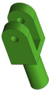
Рисунок 5.17 – Типи елементів складальної оснастки, що монтуються: а – вилки; б – вушка; в – висувні фіксатори; г – упори
