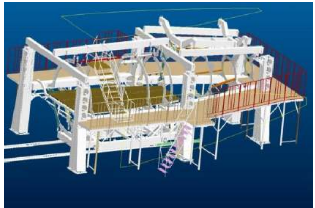
Рисунок 5.16 – Електронні 3D-моделі відсіку ФЗ (а) і стапеля складання (б) літака Ан-148 (ДП «АНТОНОВ»)
