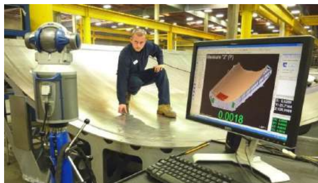
Рисунок 5.8 – Відновлення захоплення лазерного променя відбивачем при роботі в режимі XtremeADM
