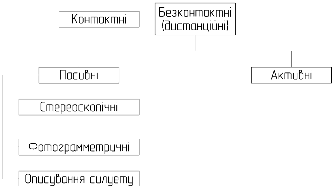
Рисунок 4.4 – Класифікація 3D-сканерів за технологією сканування
