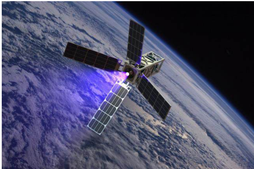
Рисунок 2.6 – Кут розходження струменя плазмового двигуна і сонячних панелей КА
