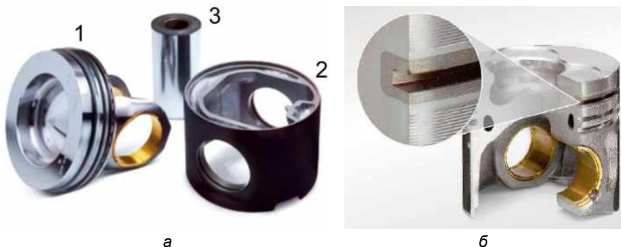
Рис. 15. Поршень двигуна SCANIA: а – складений (1 – сталевая головка с камерой згоряння; 2 – алюмінієвий тронк; 3 – палець); б – суцільний
