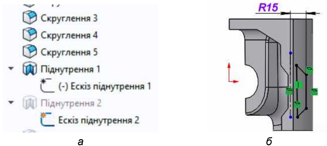
Рис. 22. Піднутрення 2 на корпусі для полегшення поршня: а – дерево побудови; б – ескіз; в – об'єм
