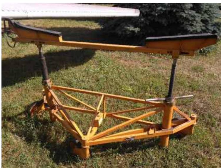
Рис. 1.7. Домкрати, призначені для аеродромного обслуговування
