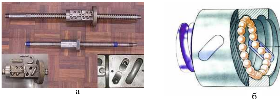
Рис. 4.1. КГП з поверненням кульок: а – за допомогою трубки; б – за допомогою вкладишів
