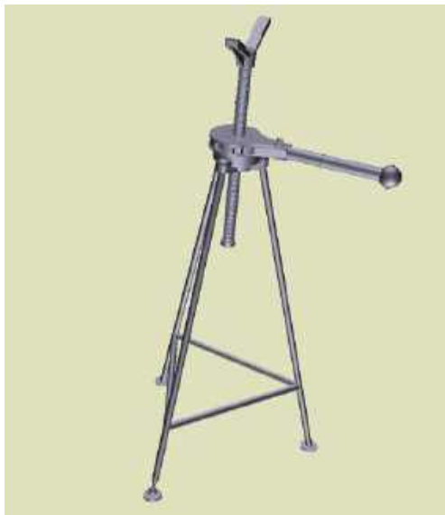
Рис. 1.7. Домкрати, призначені для аеродромного обслуговування
