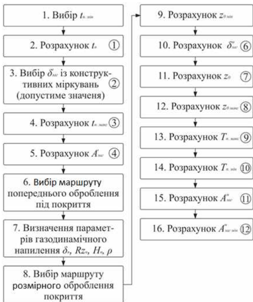
Рис. 4.5. Алгоритм розрахунку товщини покриттів та операційних розмірів на оброблення поверхонь з покриттями (цифри в колах відповідають позиціям табл. 4.1)
