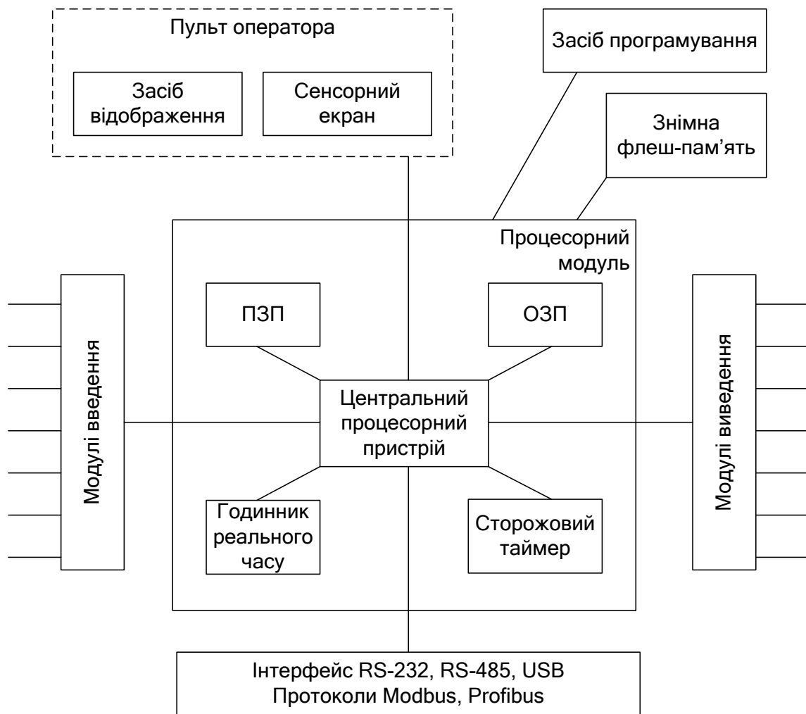
Рисунок 1.1 – Типова архітектура ПЛК
