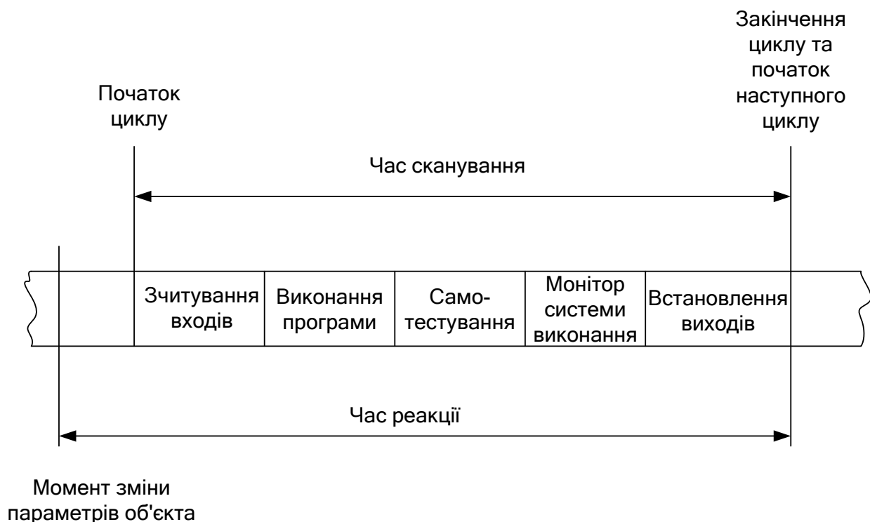
Рисунок 1.2 – Цикл роботи ПЛК і час реакції
