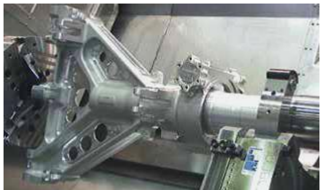
Рис. 6.1. Технологічні можливості багатоопераційних верстатів компанії WFL Millturn: а – приклад оброблення стояка головного шасі на верстаті моделі M65; б – токарна обробка амортизаційного стояка носового шасі; в – позначення переміщень виконавчих механізмів багатоопераційних верстатів WFL Millturn; г – фрезерна обробка вушка амортизаційного стояка; д – спіральне фрезерування рами візка головного шасі; е – зубонарізання для рульового механізму носового стояка; ж – приклад закріплення стояка носового шасі на планшайбі та пінолі задньої бабки верстата; и – приклад закріплення стояка носового шасі на планшайбі та люнеті верстата моделі M65
