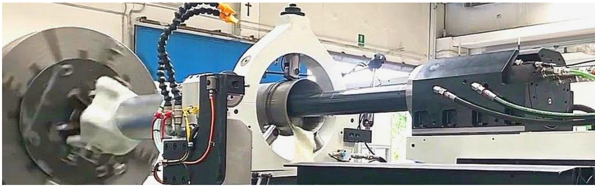
Рис. 5.3. Приклад патронного внутрішнього круглого шліфування амортизаційного стояка шасі пасажирського літака
