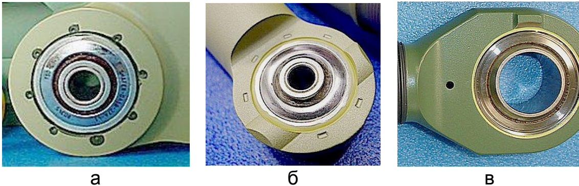
Рис. 8.4. Зовнішній вигляд деталі літака із запресованим сферичним підшипником ковзання після кернування (а), розчеканювання (б) та роликового розкочування (в) зовнішнього кільця з V-подібним пазом
