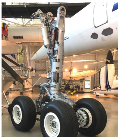
Рис. 1.3. Візок основного шасі пасажирського літака: а – комп'ютерна модель основних конструктивних елементів; б – відпрацювання етапів прибирання та випускання тривісного візка основного шасі пасажирського літака-аеробуса в цеху остаточного складання літака; в – двовісний візок основного шасі магістрального пасажирського літака; г – приклад етапу складання-монтажу двовісного візка основного шасі пасажирського літака-аеробуса
