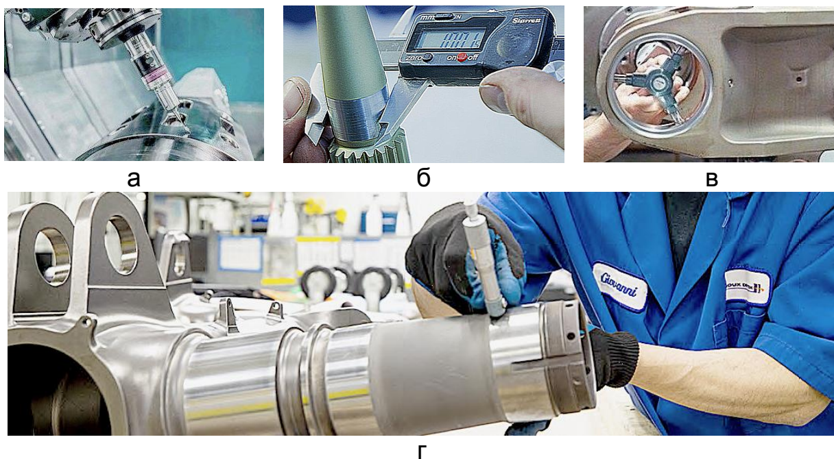
Рис. 7.2. Вимірювальна головка (а) та вимірювальні інструменти (б, в, г) для операційного геометричного контролю деталей шасі літака
