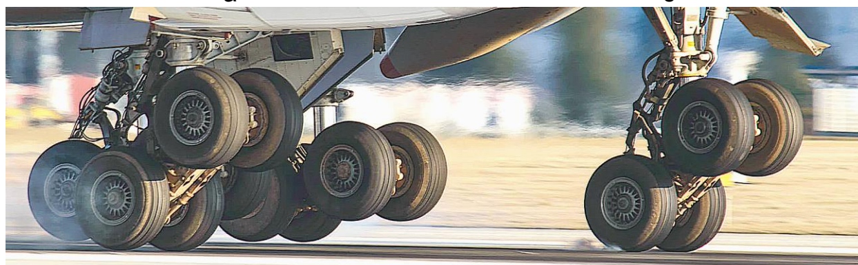
Рис. 1.10. Схема (а) та загальний вигляд чотириколісного двовісного візка основної опори шасі літака на стоянці (б) та при посадці (в): 1 – балка шасі; 2 – гідроциліндр прибирання-випускання основної опори; 3 – тяги; 4 – вузли опорні; 5 – ступка; 6 – опора основна; 7 – шліц-шарнір; 8 – візок; 9 – вісь колеса; 10 – колесо; 11 – гальмо колеса; 12 – ланка підкосу верхня; 13 – ланка підкосу нижня; 14 – ступка фюзеляжна
