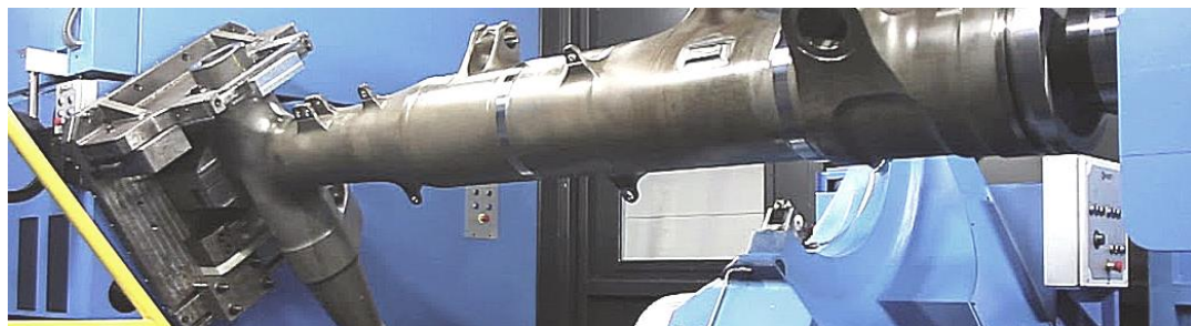
Рис. 6.3. Приклади спеціальних верстатних пристроїв для базування та закріплення заготовок стояків шасі на планшайбі верстатів WFL Millturn
