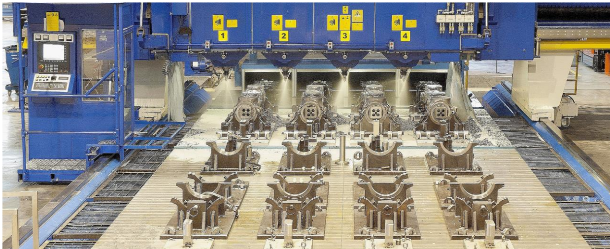
Рис. 4.5. Групова фрезерна обробка заготовок амортизаційних стояків шасі літака
