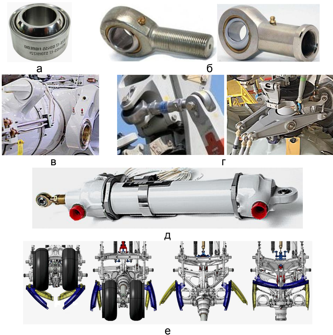
Рис. 8.1. Приклади розташування сферичних підшипників ковзання та шарнірних головок у механічній системі керування літальним апаратом, стояках і тягах стулок шасі пасажирського літака
