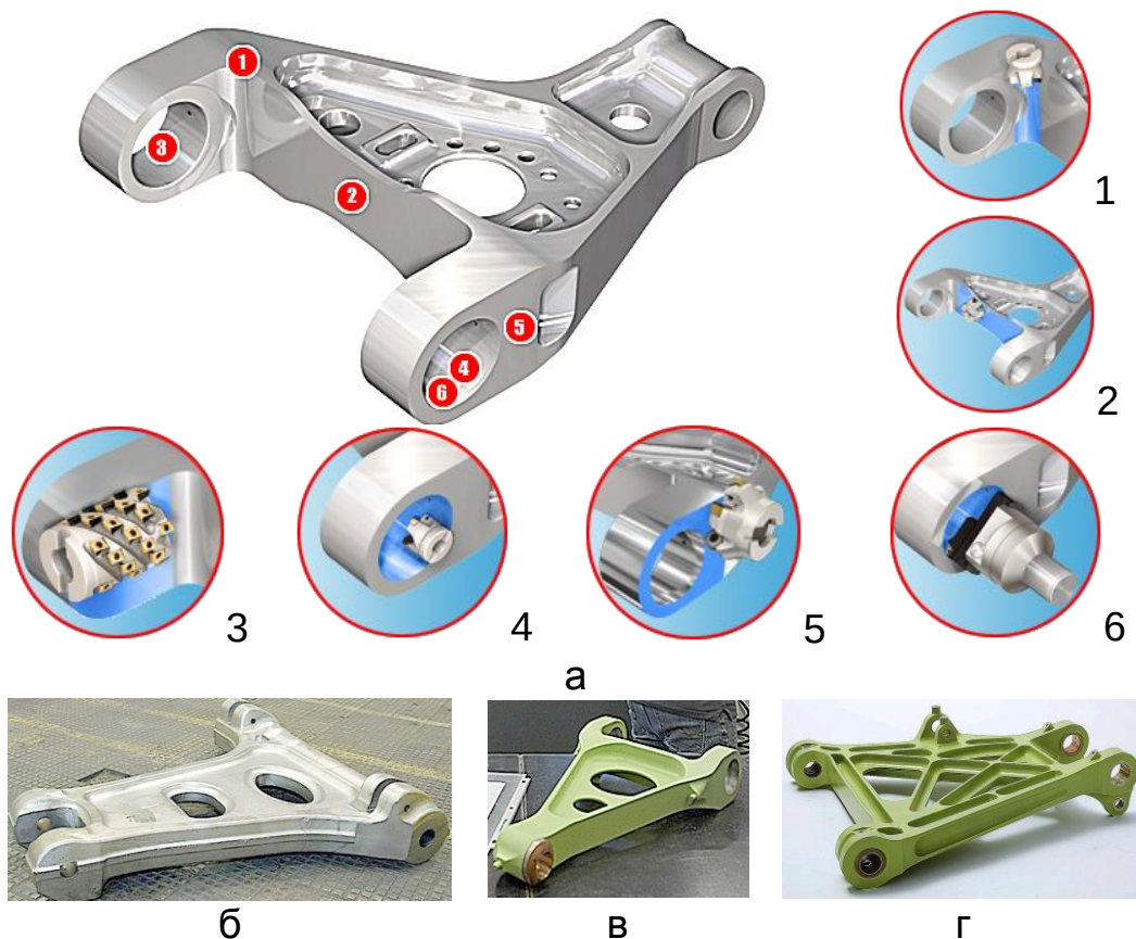
Рис. 4.9. Схема послідовності оброблення (а), загальний вигляд заготовки (б) та вузлів шліц-шарніра із запресованими втулками (в, г): 1 – фрезерування галтелі; 2, 3, 5 – фрезерування площин; 4 – свердління наскрізних отворів; 6 – розточування наскрізних отворів
