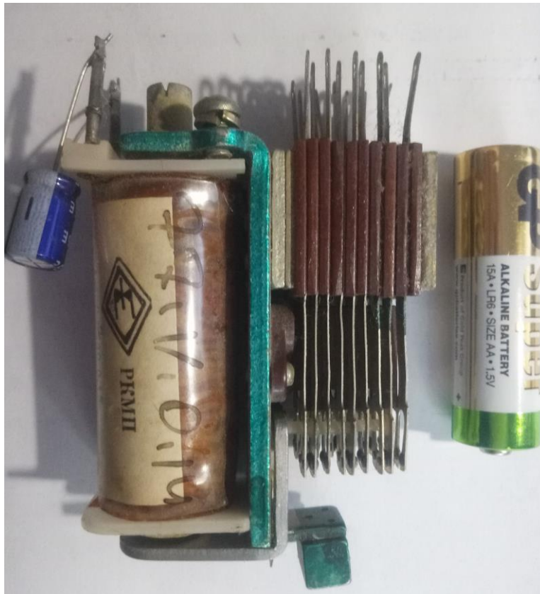
Рис. 1.2. Електромагнітне реле типу РКМП (6 груп, 24 В, паспорт РС 4.523.621, Ag – 0.71г)
