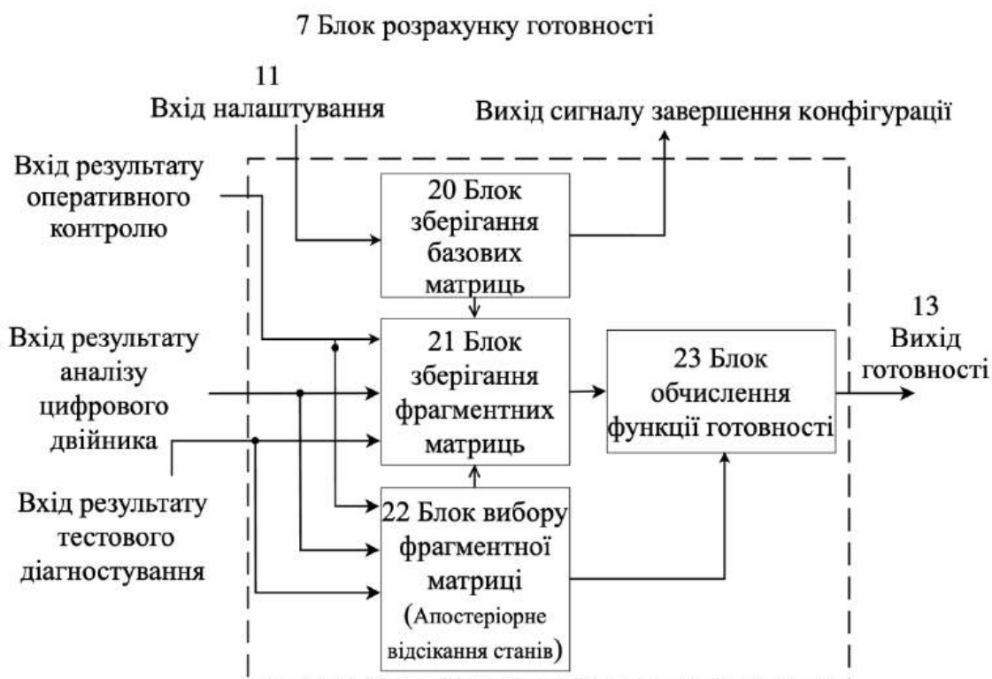
Рисунок 2.3 – Внутрішня структура блока розрахунку готовності (E)
