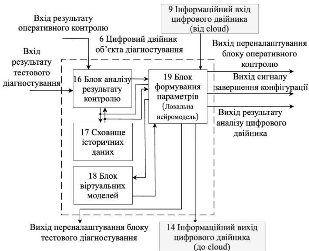
Рисунок 2.2 – Структура цифрового двійника об'єкта діагностування (DTedge)
